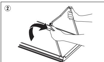
脚部を矢印方向へ回転させながら起こします。反対側の脚部も同様です。
